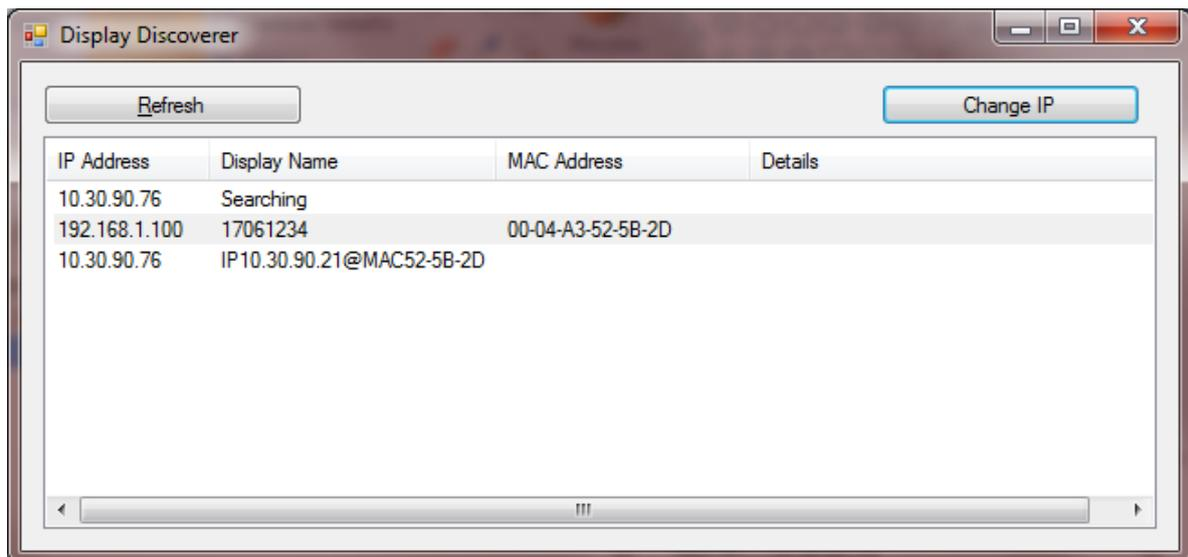
Après quelques secondes si on clique sur "Recherche Dispositif", l'afficheur apparaît avec la nouvelle IP.
