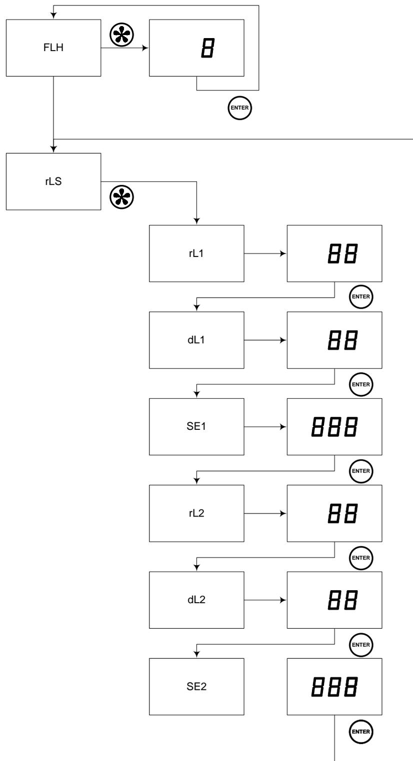
Le diagramme de paramètres est la suivante lorsque l'afficheur comporte pas l'option de couleur:
