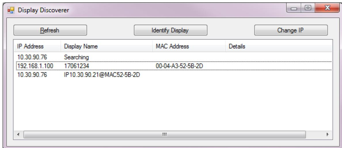
Après quelques secondes si on clique sur "Recherche Dispositif", l'afficheur apparaît avec la nouvelle IP.
