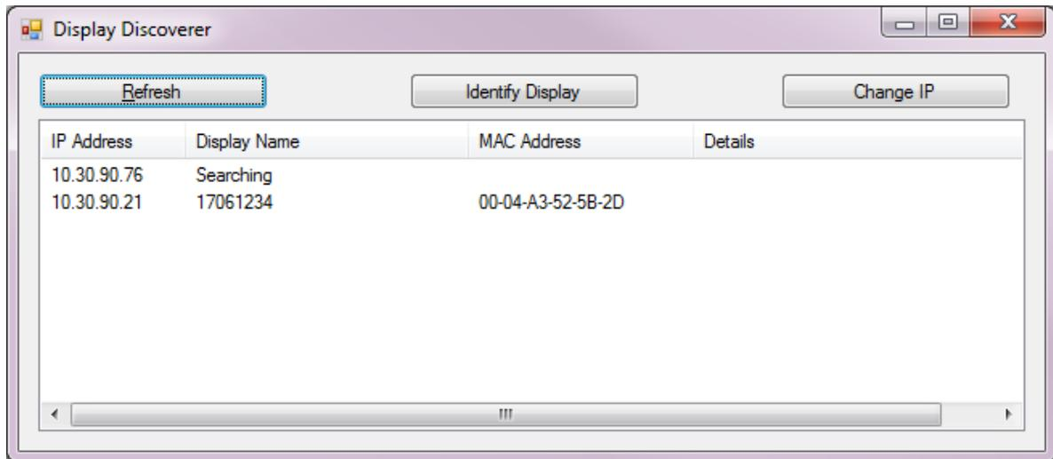
Si on clique sur l'adresse IP de l'afficheur, le navigateur par défaut du PC s'ouvre et l'on accède à la page web de l'afficheur.
