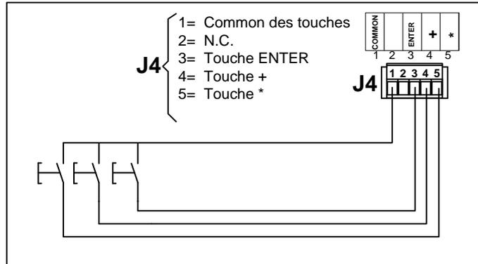
En le boîtier d'acier inoxydable, les touches sont connectées avec Terminal Blocks.
