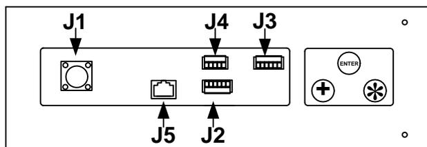
Les connecteurs de signal se trouvent sur la partie inférieure de l'appareil. Les connecteurs disponibles varient en fonction des options dont l'appareil est équipé.
