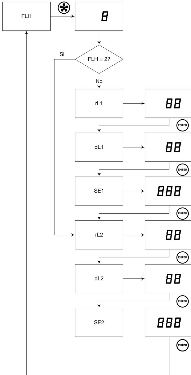
Le diagramme de paramètres est la suivante lorsque l'afficheur comporte l'option de relais et non comporte l'option de couleur:
