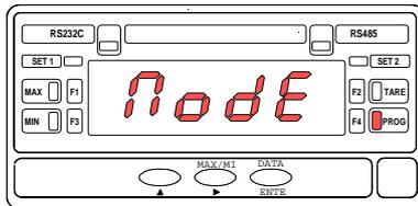
L'indication de la figure 43.2 s'affiche pendant 2 secondes avant d'entrer dans la programmation du mode de contrôle. Au bout de 2 secondes ou par pulsation sur la touche **ENTER**, on fait apparaître à l'affichage le numéro correspondant au mode initialement programmé (1= mode 1, 2= mode 2, 3= mode 3 ou 4= mode 4).
