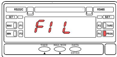
Dans ce pas de programme il est possible d'activer un filtre anti-rebond avec une fréquence de coupage de 20Hz.
