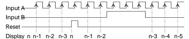
L'instrument incrémente ou décrémente la valeur de l'affichage à chaque impulsion de l'entrée A seulement quand l'entrée B est au niveau bas. Le comptage reste figé durant tout le temps que l'entrée B se maintiendra au niveau haut.
