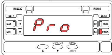
A partir du mode travail, appuyer sur **ENTER** pour accéder au mode programmation et appuyer répétitivement **▶** jusqu'à ce que l'affichage montre l'indication de la figure 43.1 (display **Pro**, leds **PRG**, **SET1** et **SET2** activées). Dans ce module il est possible de sélectionner l'un des quatre modes de contrôle disponibles, le type d'activation de chaque sortie de relais et, en cas de sortie impulsionnelle, la largeur de l'impulsion.
