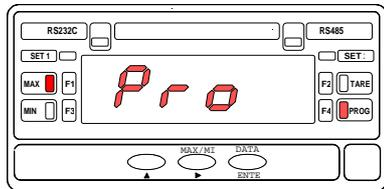
La figure 19.1 présente l'indication correspondante au niveau d'accès au module de programmation de l'entrée. A partir du mode de travail, appuyer sur **ENTER** et **▶** pour accéder à cette phase.
