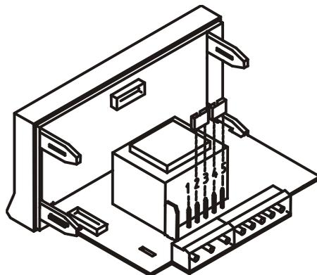
Fig. 9.2. Sélecteur d'alimentation par 230 V ou 48 V AC
