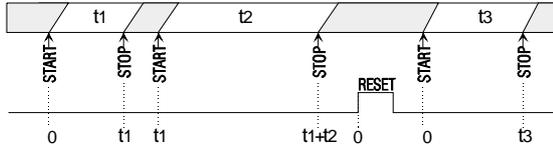
La mesure de temps peut être réalisée dans l'une des cinq échelles disponibles : 99.99s, 999.9s, 9999s, 99min59s ou 9999h.
