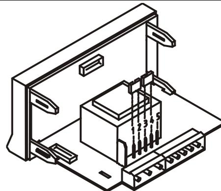
Fig. 9.3. Sélecteur d'alimentation par 115 V ou 24 V AC
