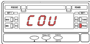
Un appui sur **ENTER** dans le pas antérieur permet d'accéder à la sélection du compteur (indication **COU**) ou du chronomètre (indication **CHro**).
