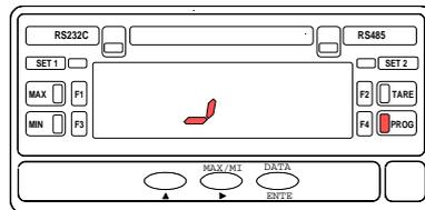
A partir de l'appui sur **ENTER** dans le pas précédent, l'affichage montre l'une des deux indications de la figure 44.1 (selon la configuration antérieure). La led **SET1** indique que la sélection du type de sortie sera affectée au seuil 1.
