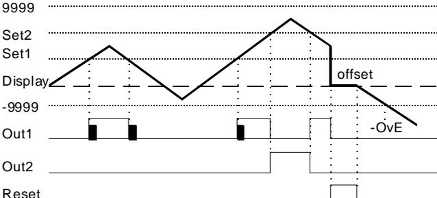
Dans les diagrammes sont données les réponses des relais (Out1 et Out2) en mode impulsionnel (
