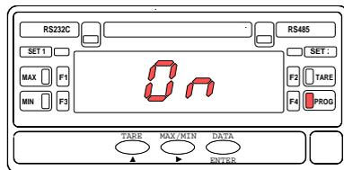
La figure 27.3 montre l'affichage de l'entrée dans la phase de sélection du mode de fonctionnement du chronomètre. Au bout de 2 secondes ou au moyen de la touche **ENTER**, on fera apparaître l'indication correspondante au mode programmé antérieurement: **Ind** = INDEPENDANT, **dir** = DIRECTIONNEL.
