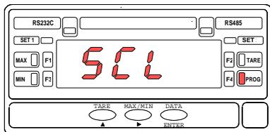
L'indication de la fig. 30.2 s'affiche pendant 2 secondes avant d'entrer dans la programmation de l'échelle. Après ces 2 secondes ou par **ENTER** on fera apparaître la valeur de l'échelle initialement programmée :
