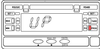
On sélectionne dans ce pas de programme la façon de travailler en mode ascendant (**UP**), descendant (**DOWN**) ou bidirectionnel (**UP.DO**).
