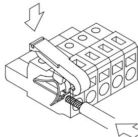
Pour effectuer les raccordements, débrocher le connecteur femelle monté dans la fiche dormante de l'appareil, introduire l'extrémité dénudée du fil correspondant à chacun des points de raccordement dans son logement en ouvrant celui-ci par action sur le levier (voir figure) et en le relâchant pour pincer l'extrémité du câble dénudé. Procéder ainsi avec tous les points de raccordement du connecteur puis ré-enficher ce dernier.
