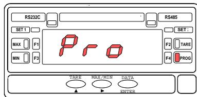
La figure 27.1 montre l'affichage correspondant au niveau d'accès au module de programmation de l'entrée.
