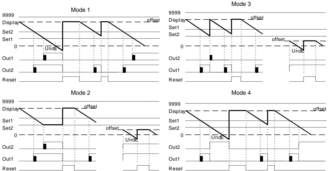
Dans les diagrammes sont données les réponses des relais (Out1 et Out2) en mode impulsionnel (■) et en mode maintenu (□).
