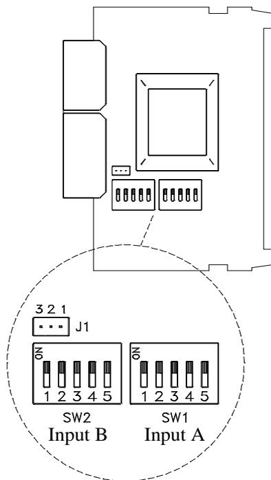
Avant de raccorder le signal d'entrée, sélectionner le type de capteur qui sera raccordé l'entrée A au moyen du switch SW1 et à l'entrée B au moyen du switch 2.
