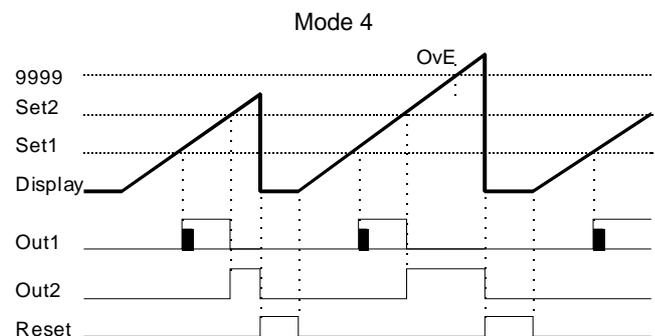
Dans les diagrammes sont données les réponses des relais (Out1 et Out2) en mode impulsif (■) et en mode maintenu (□).
