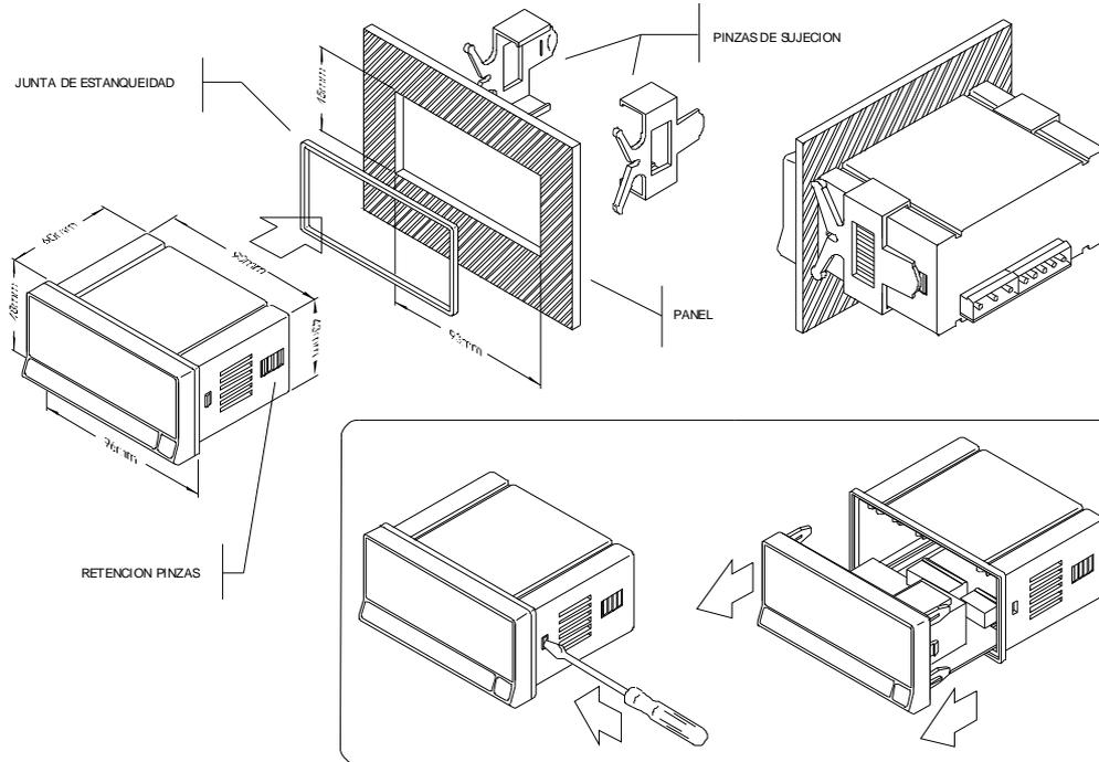
Pour monter l'instrument en tableau, pratiquer un orifice de dimensions 92x45mm et introduire l'instrument par l'avant en plaçant le joint d'étanchéité entre la collerette du cadre du boîtier et le panneau.
