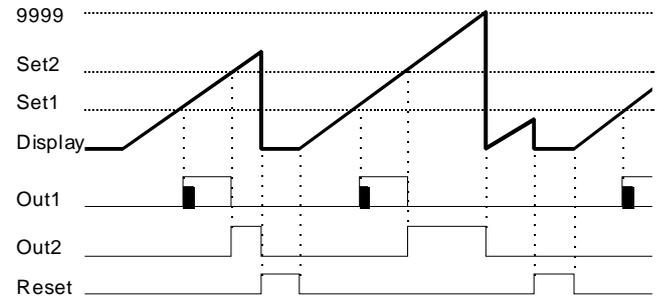
Dans les diagrammes sont données les réponses des relais (Out1 et Out2) en mode impulsionnel (■) et en mode maintenu( □ ).
