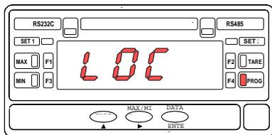
L'accès aux fonctions de blocage se fait à partir des phases 20.6 ou 21.1 au moyen d'un appui de 3 secondes sur ENTER. Ce temps écoulé, l'affichage donné l'indication correspondante à l'entrée dans la sub-routine des fonctions de blocage (fig. 22). L'indication **LOC** s'affiche pendant 2 secondes et, à sa disparition, l'indication est une combinaison de zéros et de 1, selon la configuration antérieure, avec le premier digit clignotant.
