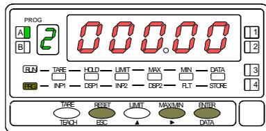
Programmation du point décimal (déplacement possible lorsque le point clignote). Par **ENTER** déplacer le point décimal au digit désiré. Si on ne veut aucun point décimal, le placer à la droite du dernier digit. La position choisie sera fixée pour toutes les valeurs de l'affichage.
