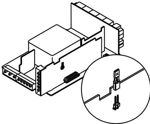
Fig. 14.3: Pont d'excitation de 5V
