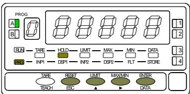
La figure 19.1 donne l'indication (SCAL) correspondante à l'entrée dans le menu de configuration de l'échelle. Appuyer sur **ENTER** pour accéder à ce menu.
