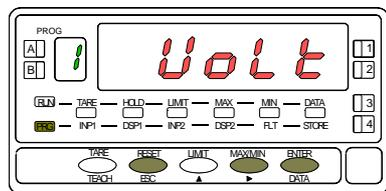
L'affichage indique le type d'entrée à programmer. Si on désire changer ce paramètre, donner des impulsions successives sur **▶** jusqu'à ce qu'apparaisse la sélection souhaitée [**VoLt** = entrée tension, **AMP** = entrée courant ou **Pot** = entrée potentiomètre].
