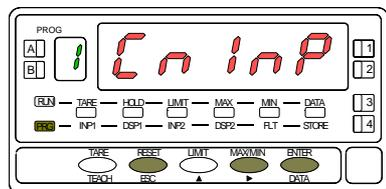
A partir du mode de travail, appuyer sur **ENTER** pour entrer dans le mode programmation (indication -Pro-). Donner une impulsion sur **▶** pour que l'affichage présente l'indication de la figure 13.1 correspondante au niveau d'accès au module de programmation de l'entrée.
