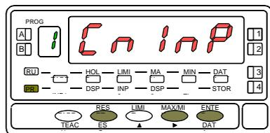
A partir du mode RUN, appuyer sur **ENTER** pour entrer dans le mode programmation (indication -Pro-). Appuyer sur la touche **▶** pour que s'affiche l'indication de la figure 14.1 correspondant au niveau d'accès au module de programmation de l'entrée.
