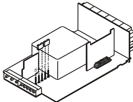
Fig. 9.3. Sélection de l'alimentation 115 V ou 24 V AC
