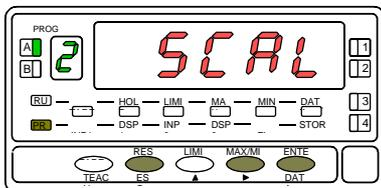
La figure 17.1 donne l'indication (**SCAL**) correspondante à l'entrée dans le menu de configuration de l'échelle. Appuyer sur **ENTER** pour accéder a ce menu.
