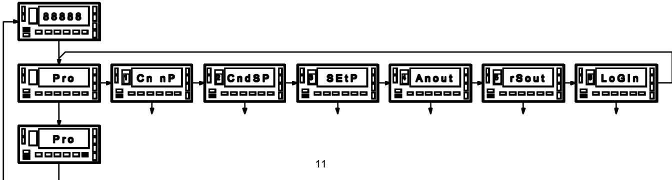
Chacun des modules de programmation se programme par une série de pas qui doivent être suivis dans l'ordre. A chaque pas sont données toutes les indications et actions possibles: un numéro de page et de figure, le titre, la figure avec l'indication de l'affichage, les leds éclairées, les touches autorisées et le texte explicatif avec les actions de chacune des touches utilisables.
