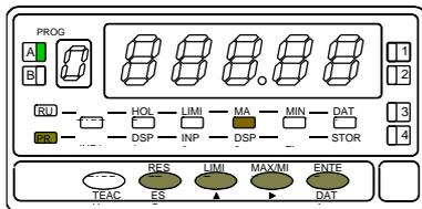
Programmation de la valeur de l'affichage au point 3, led DSP2 éclairée. Frapper la valeur digit par digit et de gauche à droite. Appuyer successivement sur ▲ pour modifier le digit clignotant et sur ▶ pour passer au digit suivant à droite jusqu'au dernier et compléter ainsi la valeur et le signe désirés. La valeur maximale est +32000 points et la valeur minimale -32000 points. Une valeur supérieure ou inférieure donnera une erreur, laissant 32000 avec le signe programmé. Après :
