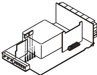
Fig. 9.2. Sélection de l'alimentation 230 V ou 48 V AC
