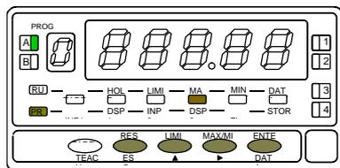
Programmation de la valeur de l'affichage au point 4, led DSP2 éclairée. Frapper la valeur digit par digit et de gauche à droite. Appuyer successivement sur pour modifier le digit clignotant et sur pour passer au digit suivant à droite jusqu'au dernier et compléter ainsi la valeur et le signe désirés. La valeur maximale est +32000 points et la valeur minimale -32000 points. Une valeur supérieure ou inférieure donnera une erreur, laissant 32000 avec le signe programmé. Après :
