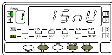
La plage sélectionnée à l'origine est affichée. Si c'est celle souhaitée, appuyer sur **ESC** pour retourner au mode RUN. Sinon, modifier ce paramètre par appuis successifs sur **▶** jusqu'à ce qu'apparaisse à l'affichage la plage souhaité parmi ["15mV", "30mV", "60mV", "300mV"].
