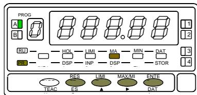
Programmation de la valeur de l'affichage au point 30, led DSP2 éclairée. Frapper la valeur digit par digit et de gauche à droite. Appuyer successivement sur ▲ pour modifier le digit clignotant et sur ► pour passer au digit suivant à droite jusqu'au dernier et compléter ainsi la valeur et le signe désirés. La valeur maximale est +32000 points et la valeur minimale -32000 points. Une valeur supérieur ou inférieure donnera une erreur, laissant 32000 avec le signe programmé. Après :
