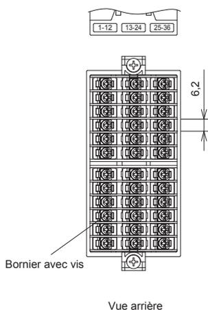
Le bornier n'est pas relié aux bornes non utilisées (bornes 13 à 24) sur certains modèles.
