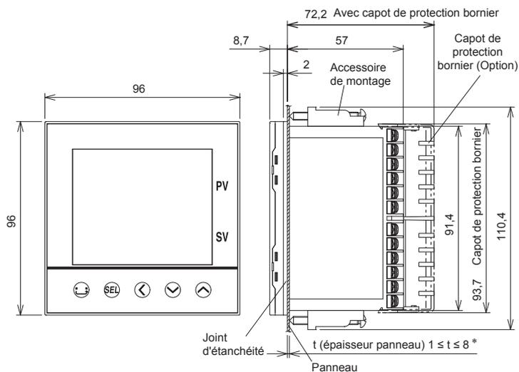
\* En cas d'utilisation d'un logiciel de configuration des paramètres avec un SW monté sur panneau : t (épaisseur panneau)  $1 \leq t \leq 4$
