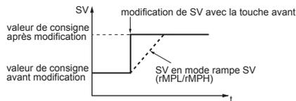
Le témoin SV clignote lorsque la rampe SV est en cours (si l'écran n'affiche pas les paramètres ou les menus). Si la rampe SV est active au moment de la mise sous tension, elle démarre à partir de la valeur de départ de PV (démarrage PV).
