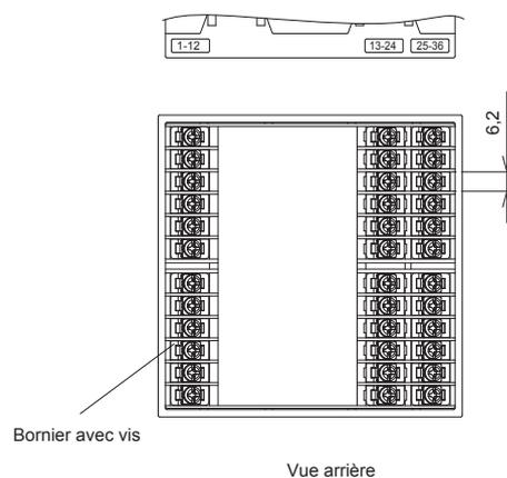
Le bornier n'est pas relié aux bornes non utilisées (bornes 13 à 24) sur certains modèles.
