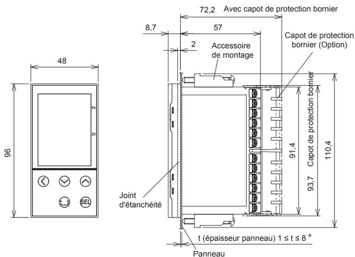
\* En cas d'utilisation d'un logiciel de configuration des paramètres avec un SW monté sur panneau : t (épaisseur panneau)  $1 \leq t \leq 4$
