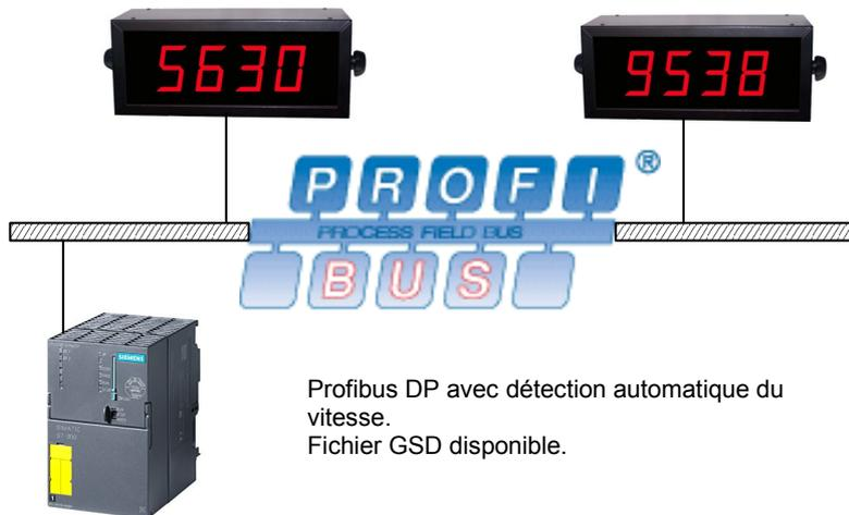
Profibus DP avec détection automatique du vitesse.
