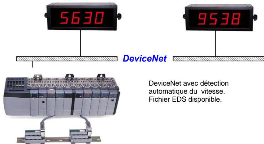
DeviceNet avec détection automatique du vitesse.
